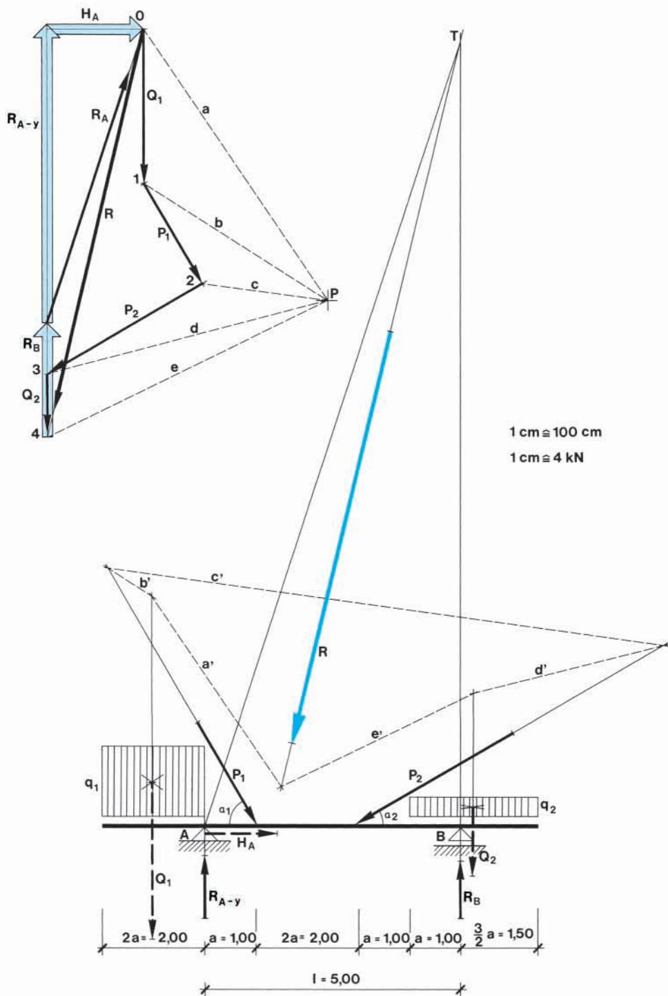
gente il punto  $A$  e l'intersezione  $T$  della  $R_B$  con la linea di azione della risultante  $R$ .
