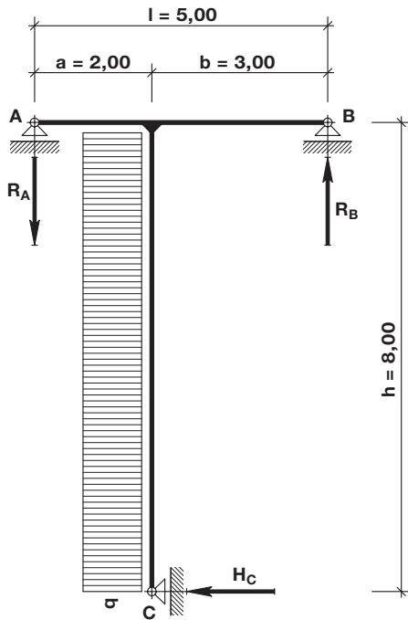
Verifica della isostaticità della struttura:
