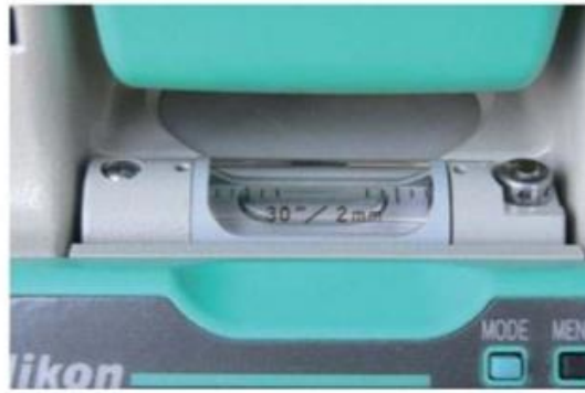
FIGURA 25 Livella torica dell'alidada; alla destra è visibile e accessibile la vite di rettificazione.
