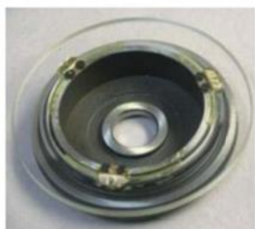
FIGURA 19 Cerchio orizzontale. I tratti della graduazione sono sottilissimi e non apprezzabili a occhio nudo.
