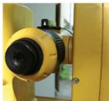
FIGURA 18 Cannocchiale collimatore con l'oculare in primo piano e con il mirino meccanico sul dorso superiore.
