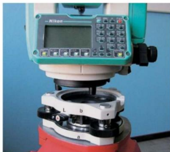
FIGURA 13 Basamento del teodolite con l'indicazione delle tre parti che lo compongono e la leva L di ritenuta dello strumento.
