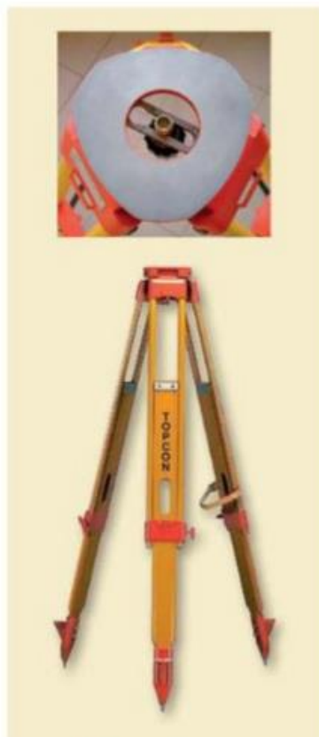
FIGURA 12 Treppiede per il montaggio dei goniometri. Nella vista dall'alto si può osservare la vite di serraggio.
