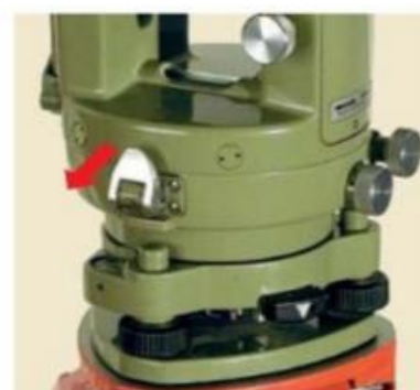
FIGURA 23 Levetta di ripetizione in primo piano. La sua posizione verticale è quella di esercizio (cerchio fisso al basamento). Rendendo orizzontale la levetta il cerchio viene fissato all'alidada per il suo trascinarsi.
