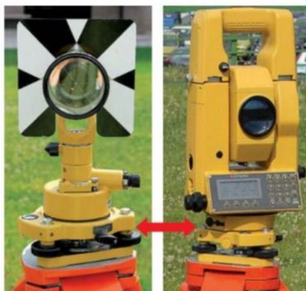
FIGURA 14 L'intercambiabilità tra teodolite e mira, che condividono lo stesso basamento, consente di mantenere il centramento sul segnale a terra.
