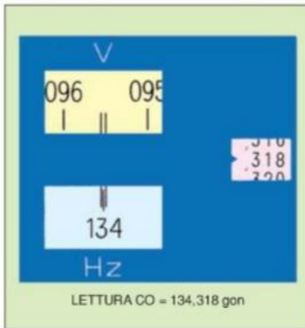
FIGURA 28 Campo del microscopio a vite micrometrica configurato per la lettura al CO.
